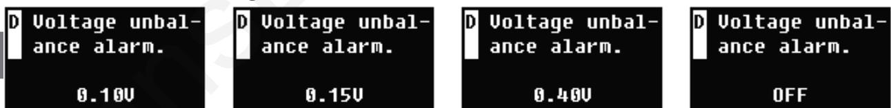
(D) Spannungsdifferenz: Liegt die Zelldifferenz über dem eingestellten Wert, wird der Alarm ausgelöst. Der Wert kann von 100 bis 400 mV gewählt werden.
