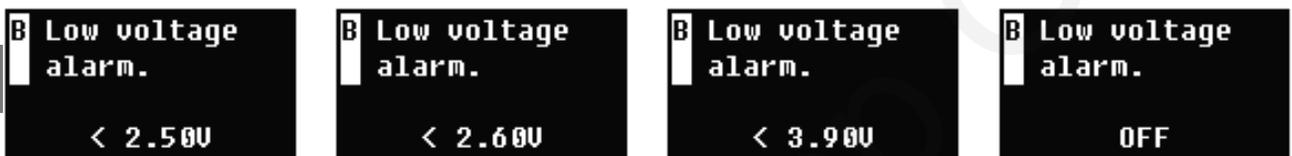
(B) Unterspannung: einstellbar von 2.5 ~ 3.9V.
