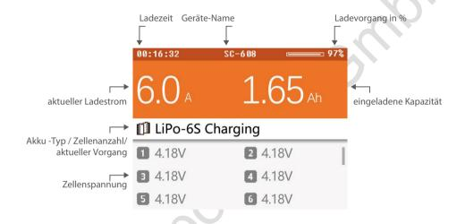
Durch drehen des Druck- und Auswahlknopfes während des Betriebs können Sie zusätzliche Informationen in der unteren Hälfte des Bildschirms anzeigen lassen. z.B Innenwiderstand der einzelnen Zellen. Zellenspannungen und Innenwiderstände können nur angezeigt werden, wenn Sie im Balanced Modus laden und das Balancer-Sensorkabel verbunden haben.
